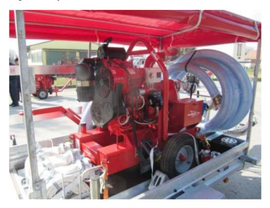
Am 26. März wurde die große Saugpumpe des BFK Krems in Spitz stationiert. 3 Kameraden holten diese nach einer Einschulung aus Steinebrunn nahe der tschechischen Grenze nach Spitz. Es handelt sich um eine selbstsaugende Kreiselpumpe mit einer maximalen Saugleistung von 200m³/Std.
